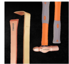
Fig. 8: Non sparking tools
