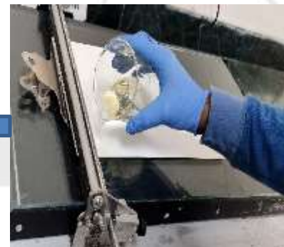
e) Pouring resin on the sheet
