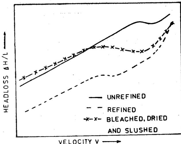
Fig. 4—TYPICAL HEADLOSS CURVES SHOWING THE EFFECT OF QUALITY OF PULP
