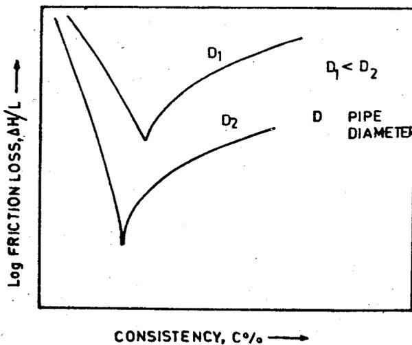
Fig. 2 TYPICAL CURVES FOR FRICTION LOSS VS CONSISTENCY
