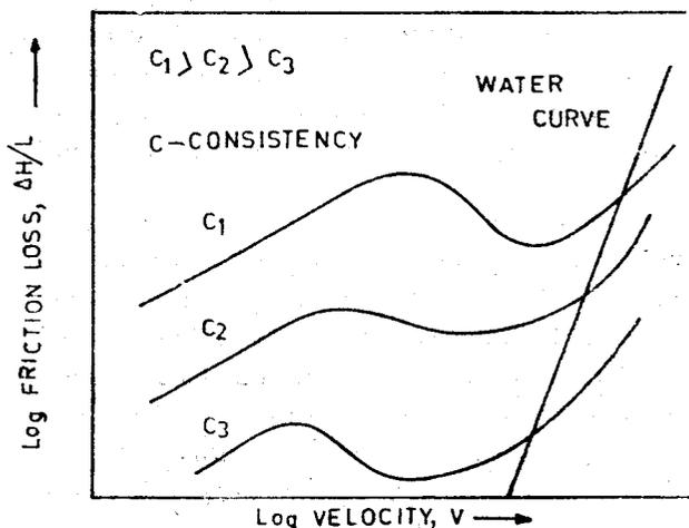
Fig. 1—TYPICAL CURVES FOR FRICTION LOSS VS VELOCITY
